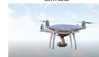
航空測量(ドローン)
