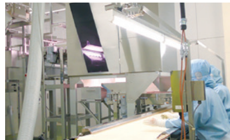
AIを搭載した生薬自動選別機および2名での生薬選別作業
