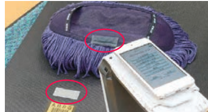
モップやマットに取り付けられたRFIDタグ(赤丸で囲った部分)。ハンディタイプの読み取り機は主に加盟店での検品や棚卸しに活用される
