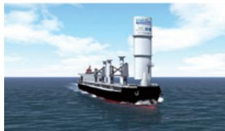
ウインドチャレンジャーおよびローターセルを搭載したばら積み船のイメージ図
