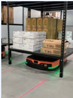
重量貨物を積載したラックを搬送する AGV(Automatic Guided Vehicle：自動搬送車)
