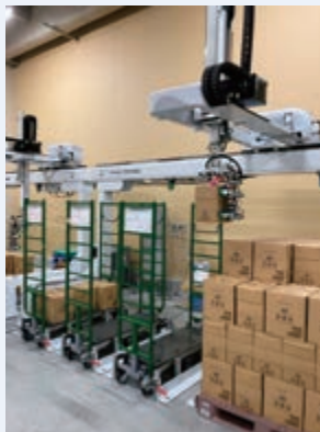
パレットに積まれた貨物を自動で 載せ替える積み付けロボット
