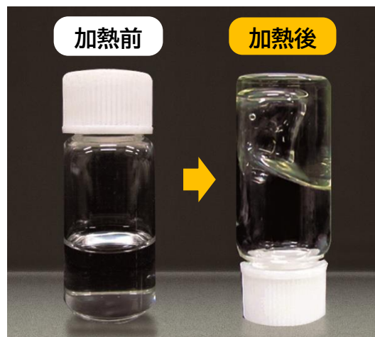
図1. 加熱処理前後の外観変化 (電解液にポリマー電解質を2wt%添加)
